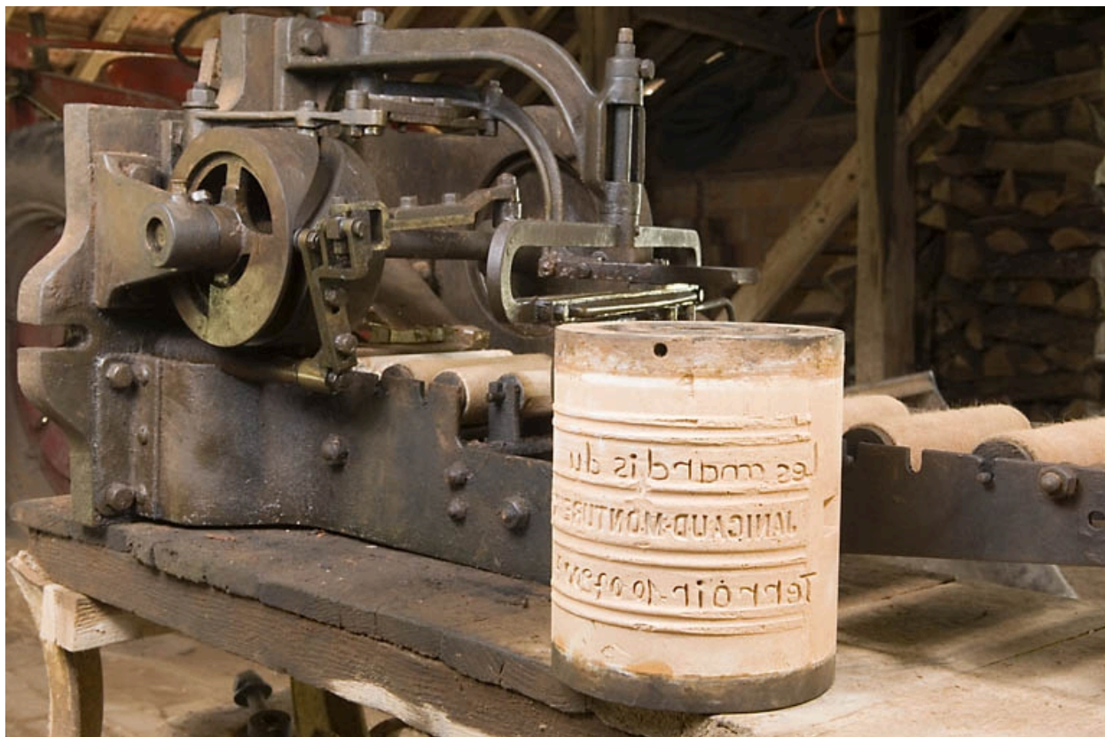
Tuilerie et briqueterie Janicot, Montureux-et-Prantigny. Mouleuse-étireuse pour tuiles et rouleau servant de matrice.
