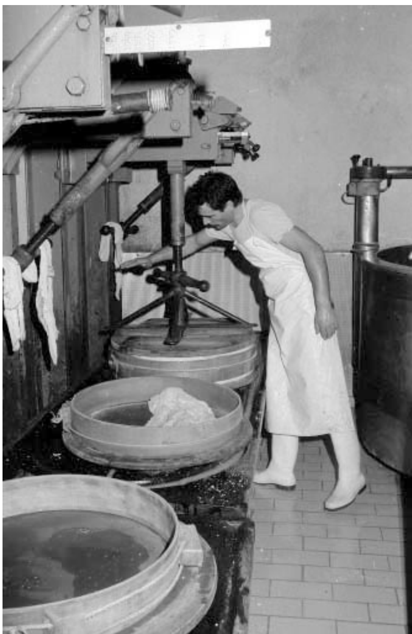
Fabrication du comté : mise sous presse.
