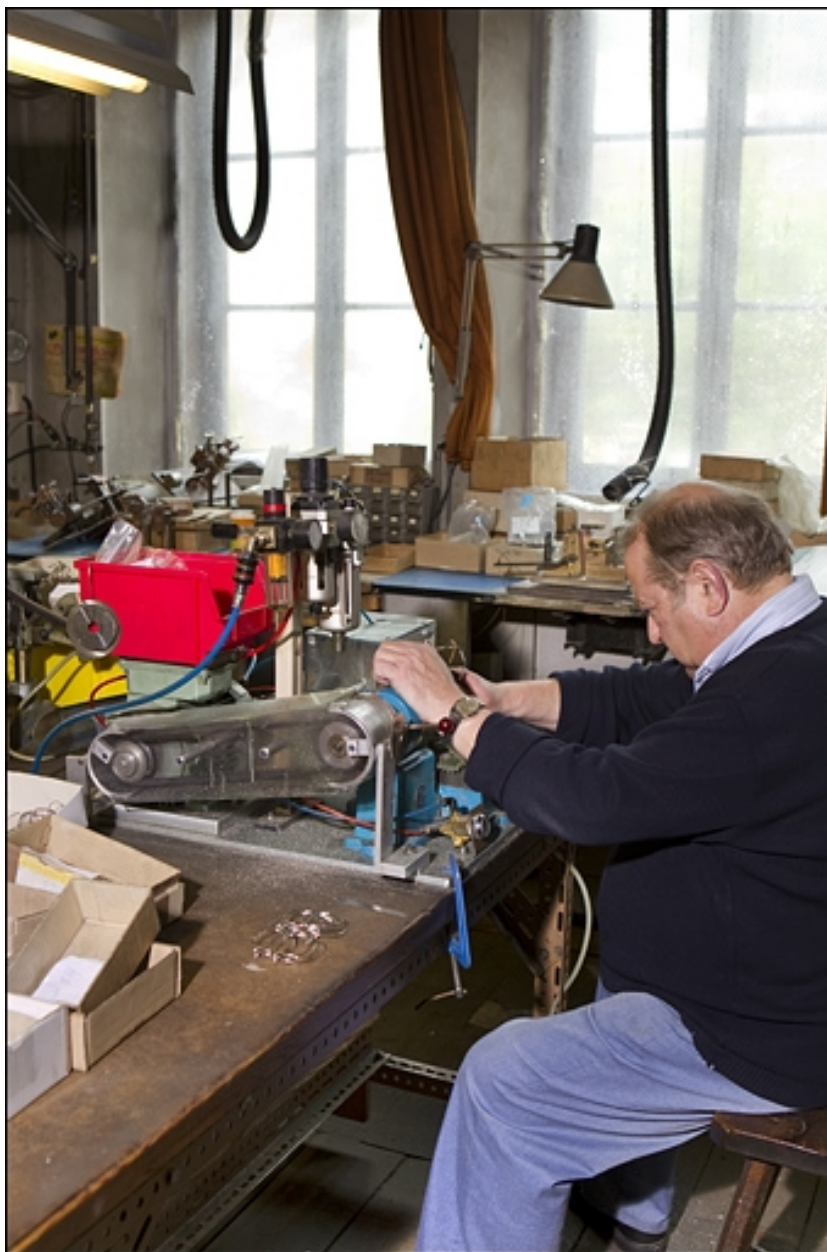
Sciage des tenons en deux.
