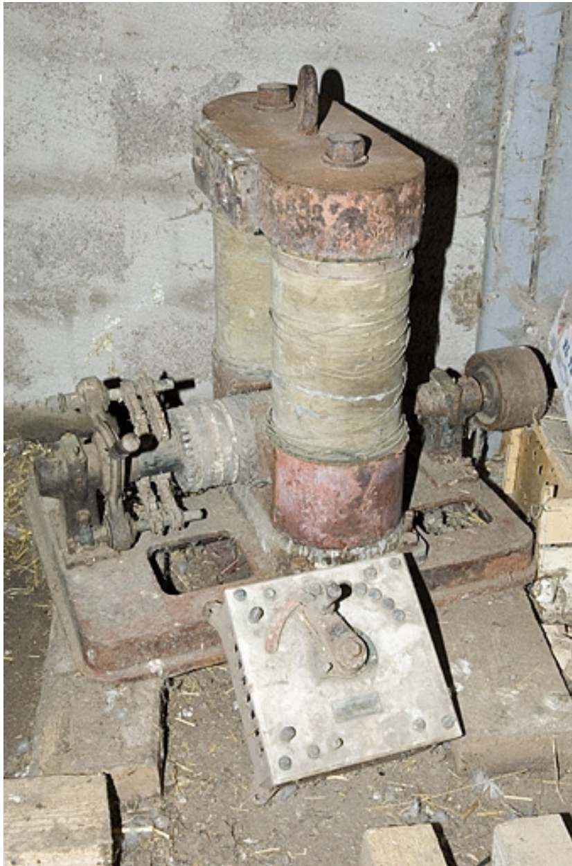
Moteur électrique Edison et tableau électrique.
