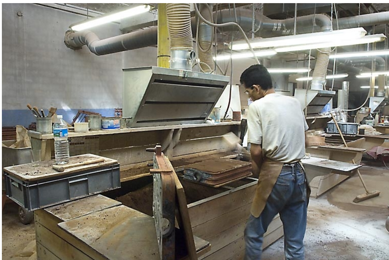
Poste de moulage. Le sable est tassé avec un instrument manuel.
