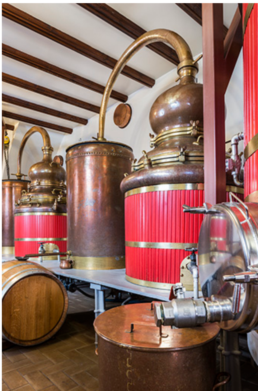
Alambics de 400 et 390 litres, provenant de l'ancienne distillerie Berthoud, à Pontarlier.
