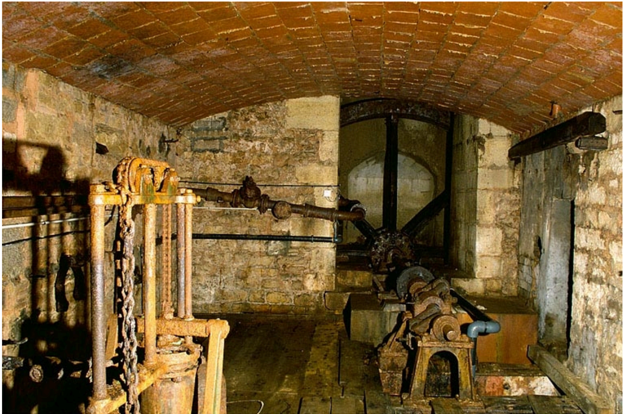
Plancher supérieur du puits à Muire. La roue hydraulique, visible au fond, actionnait une pompe située au fond du puits.
