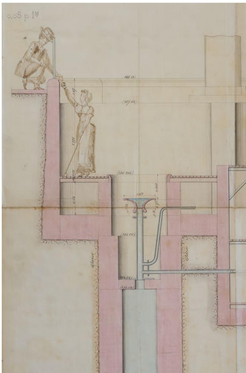
Coupe sur les deux puits avant et après l'abaissement du niveau de l'eau survenu fin avril 1891, détail de l'état postérieur.
