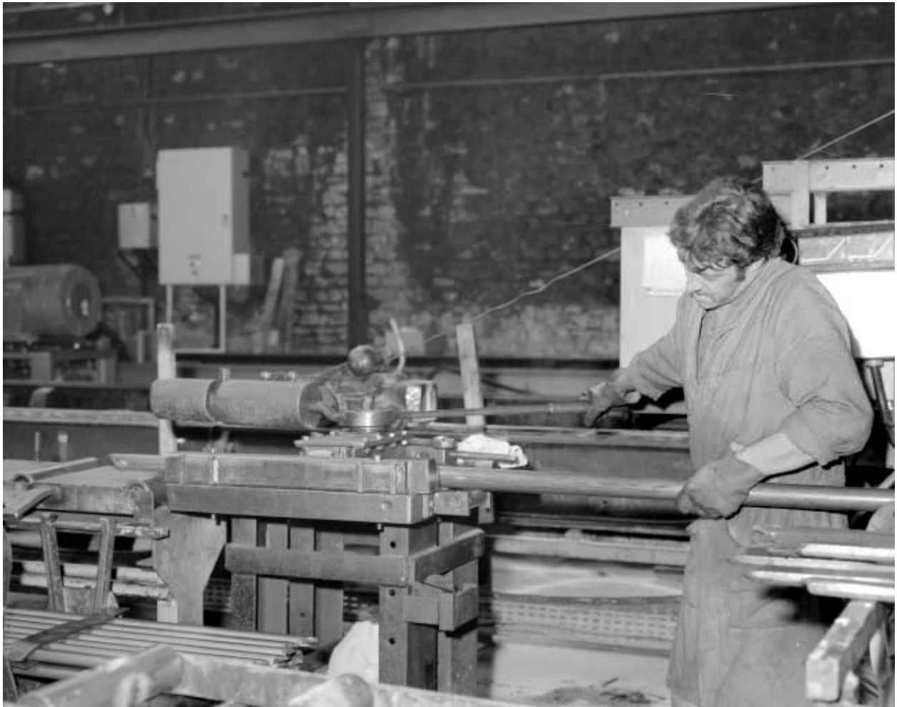
Atelier d'étirage : redressage d'une barre d'acier.
