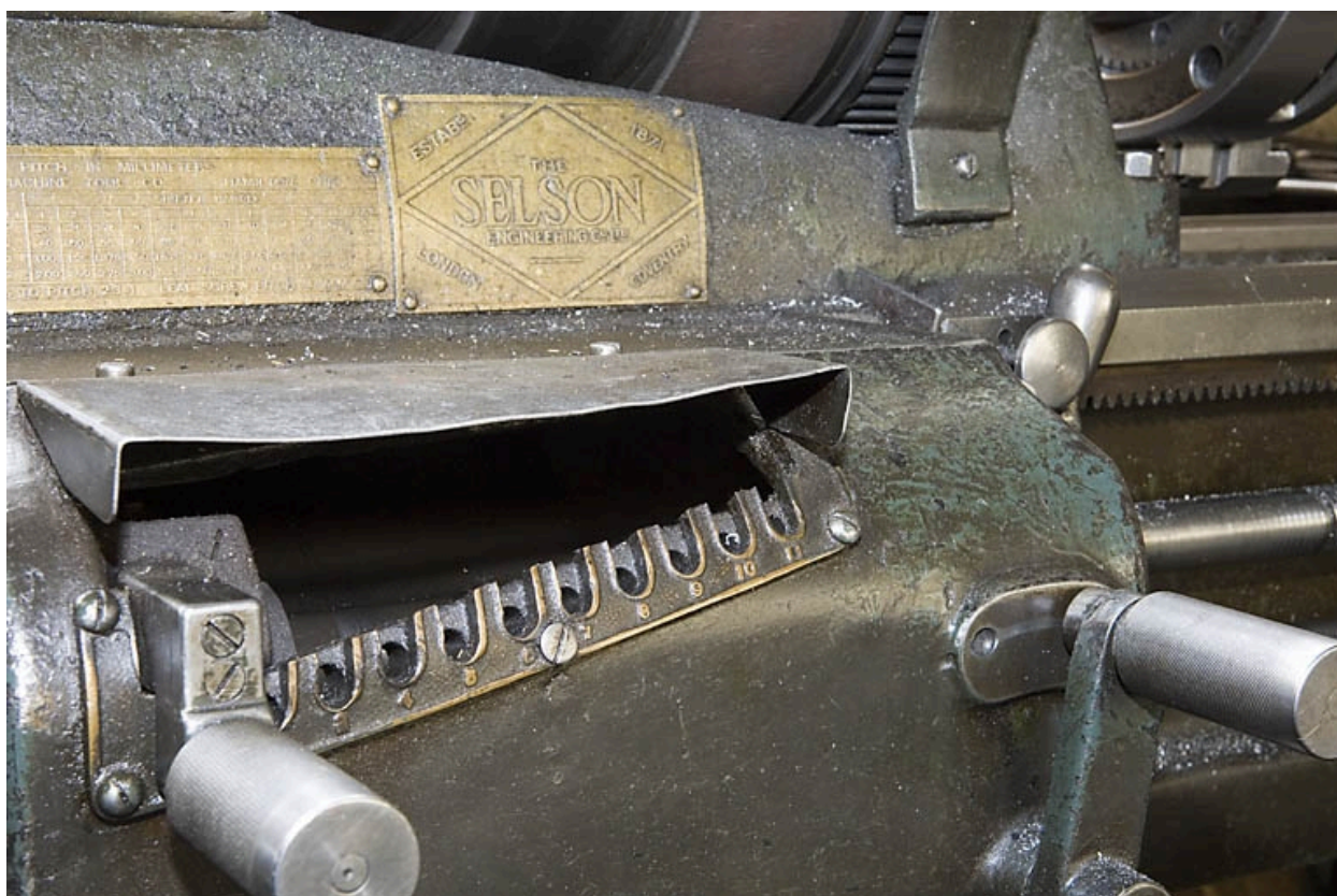
Tour horizontal parallèle Selson (A). Détail de la boîte de vitesses.
