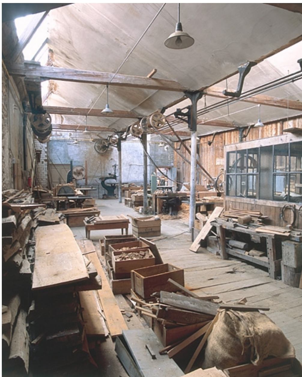
Vue d'ensemble de l'atelier de menuiserie. Axe principal à droite et axe secondaire contre le mur à gauche.
