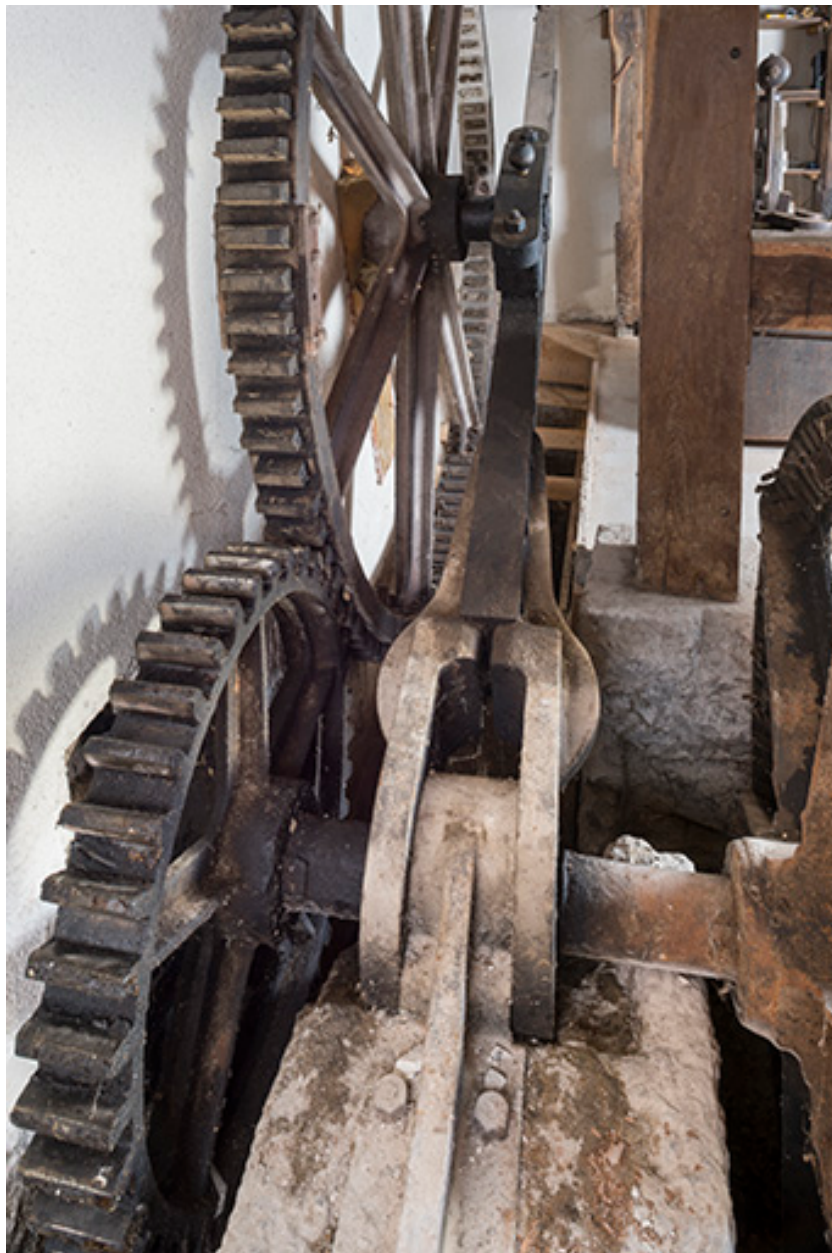
Détail des engrenages du système de levage de la roue suspendue (aval).
