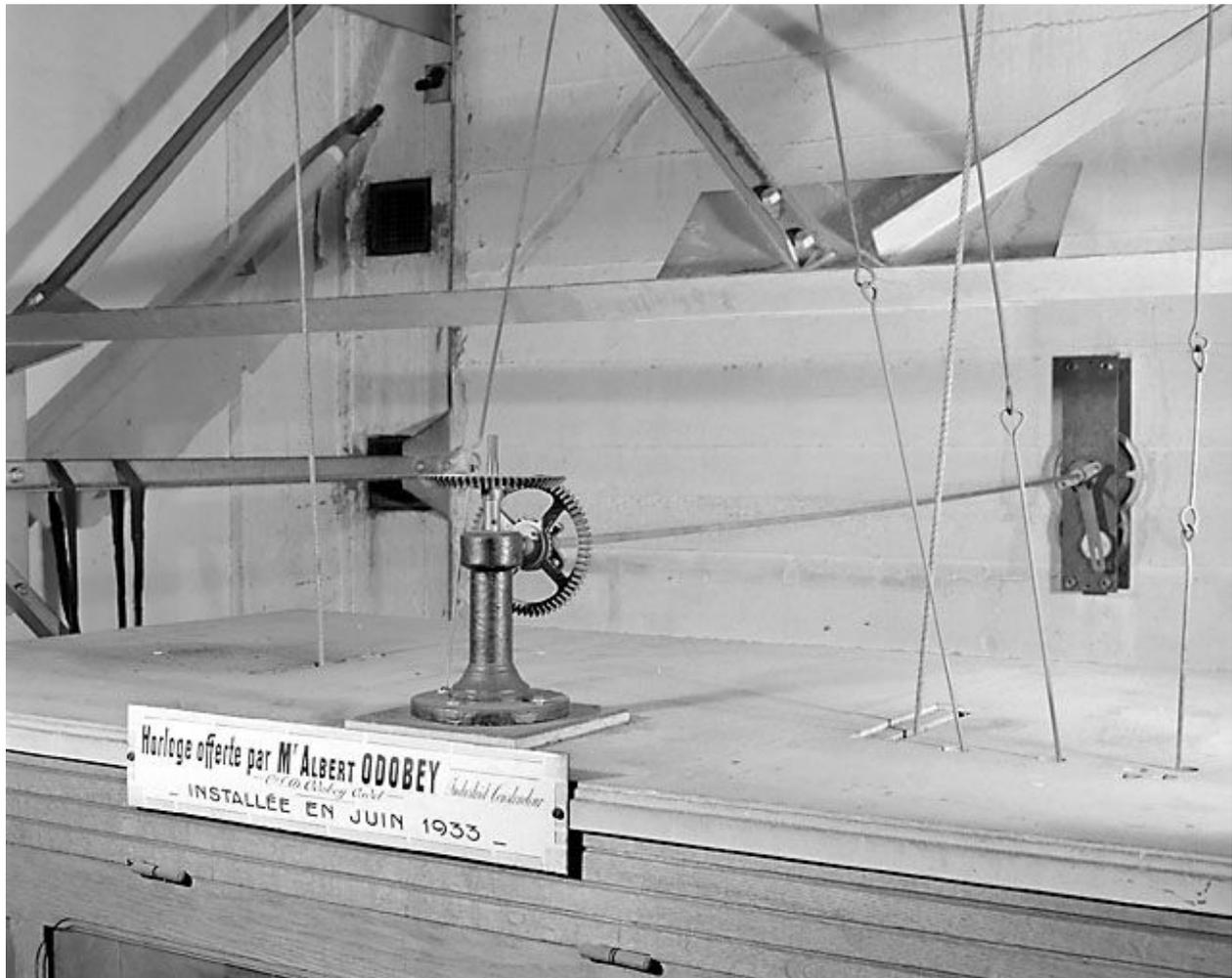
Système d'entraînement des aiguilles du cadran extérieur. Noter les tiges et les fils verticaux, qui actionnent les marteaux de tintement des cloches.
