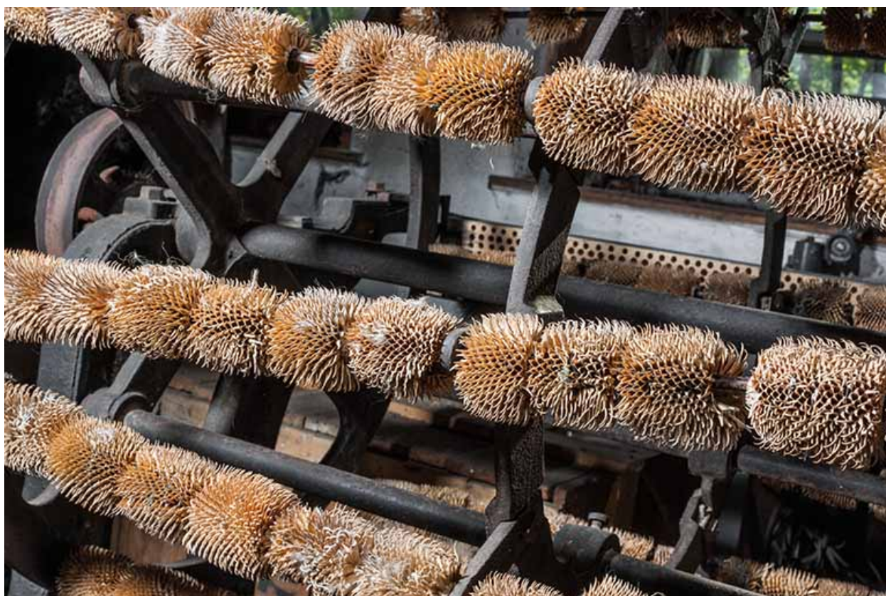
Machine à carder rotative : les cardères à foulon.
