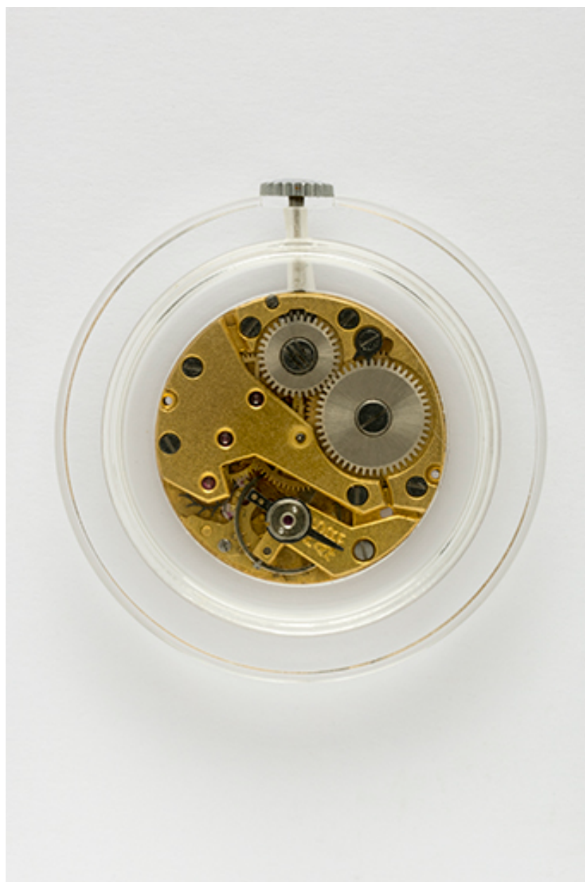
Mouvement Parrenin HP 87 : face côté ponts.
