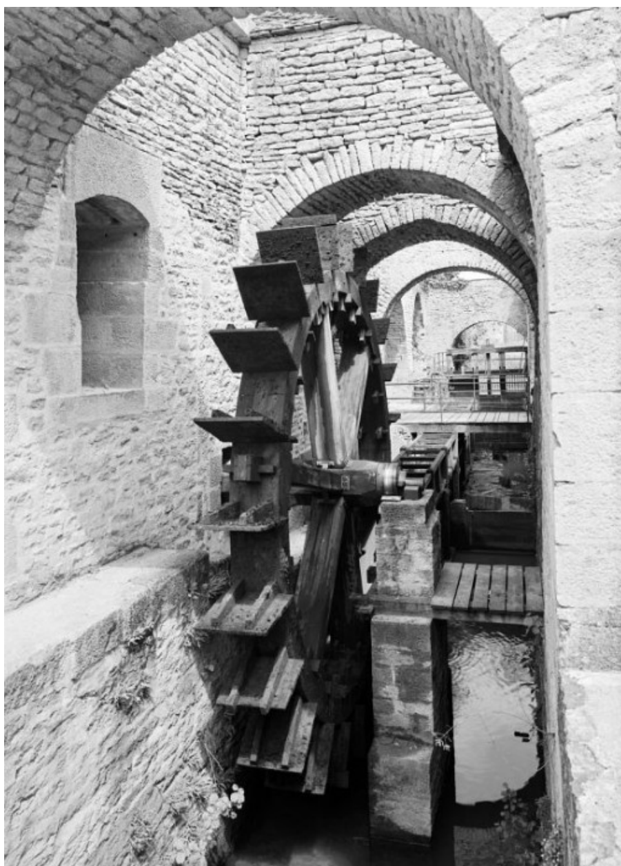
Haut fourneau, roue hydraulique reconstituée.
