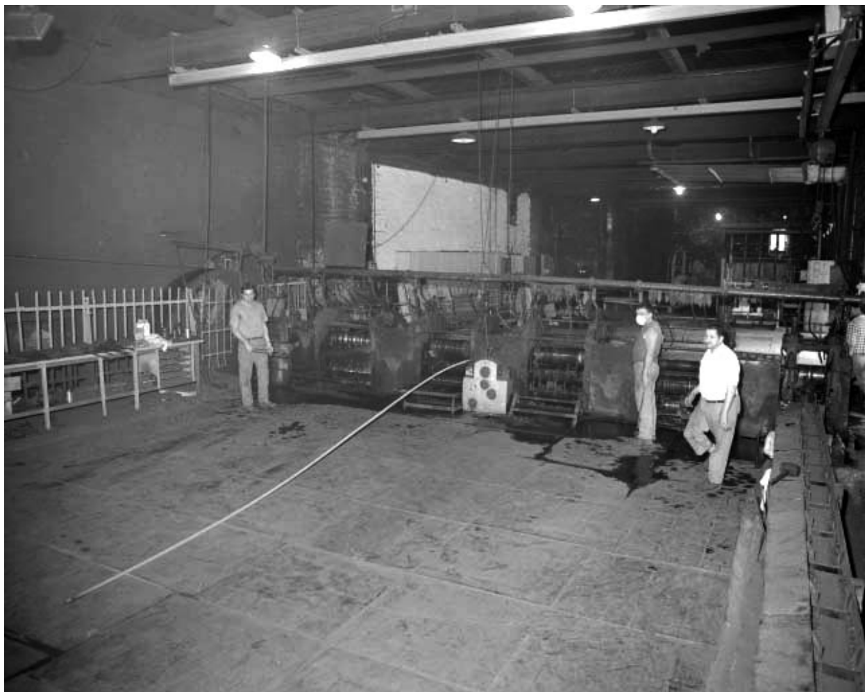
Laminoir : passage de la barre d'acier en cage de carré.
