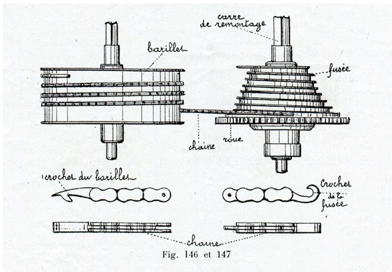
[Barillet lisse et fusée : système régularisant la force motrice transmise au rouage], 1930.
