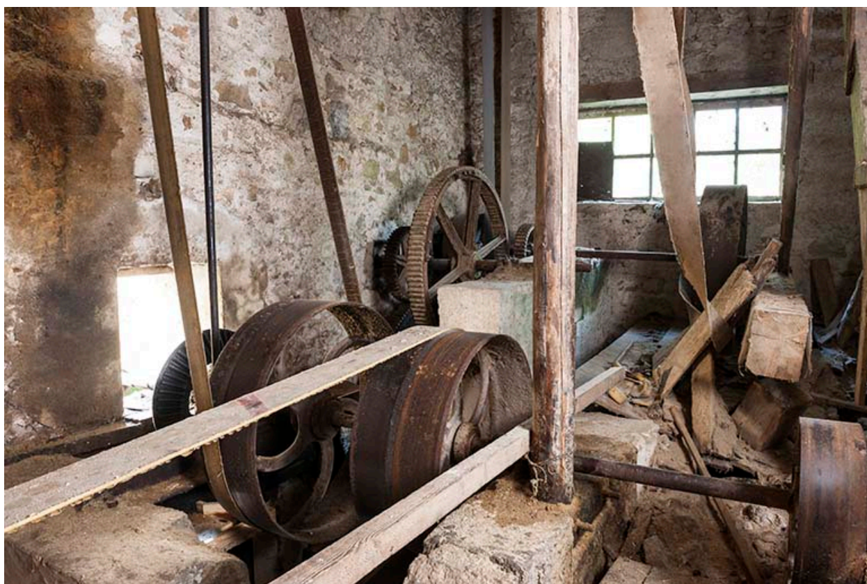
Etage de soubassement. Axe de transmission de la turbine et poulies de renvoi.
