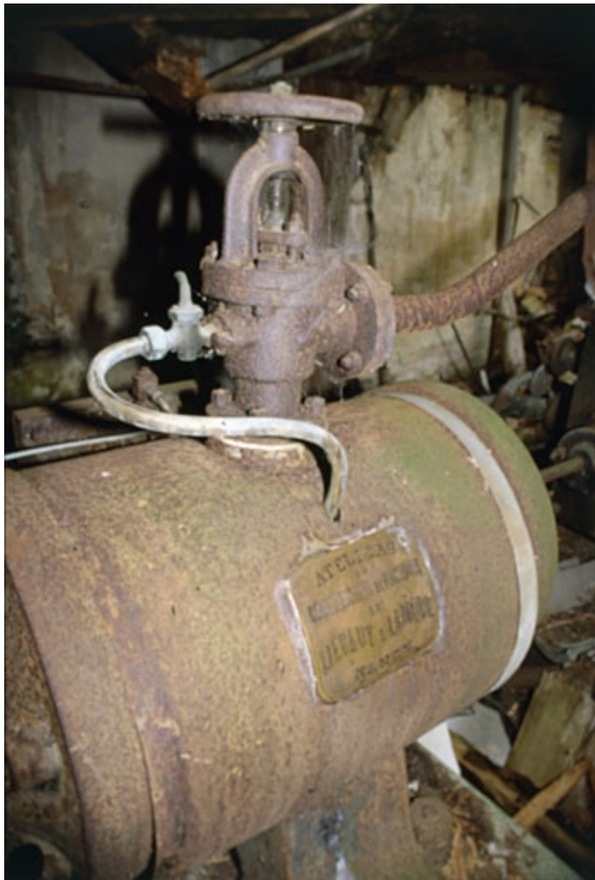
Machine à vapeur : le cylindre.
