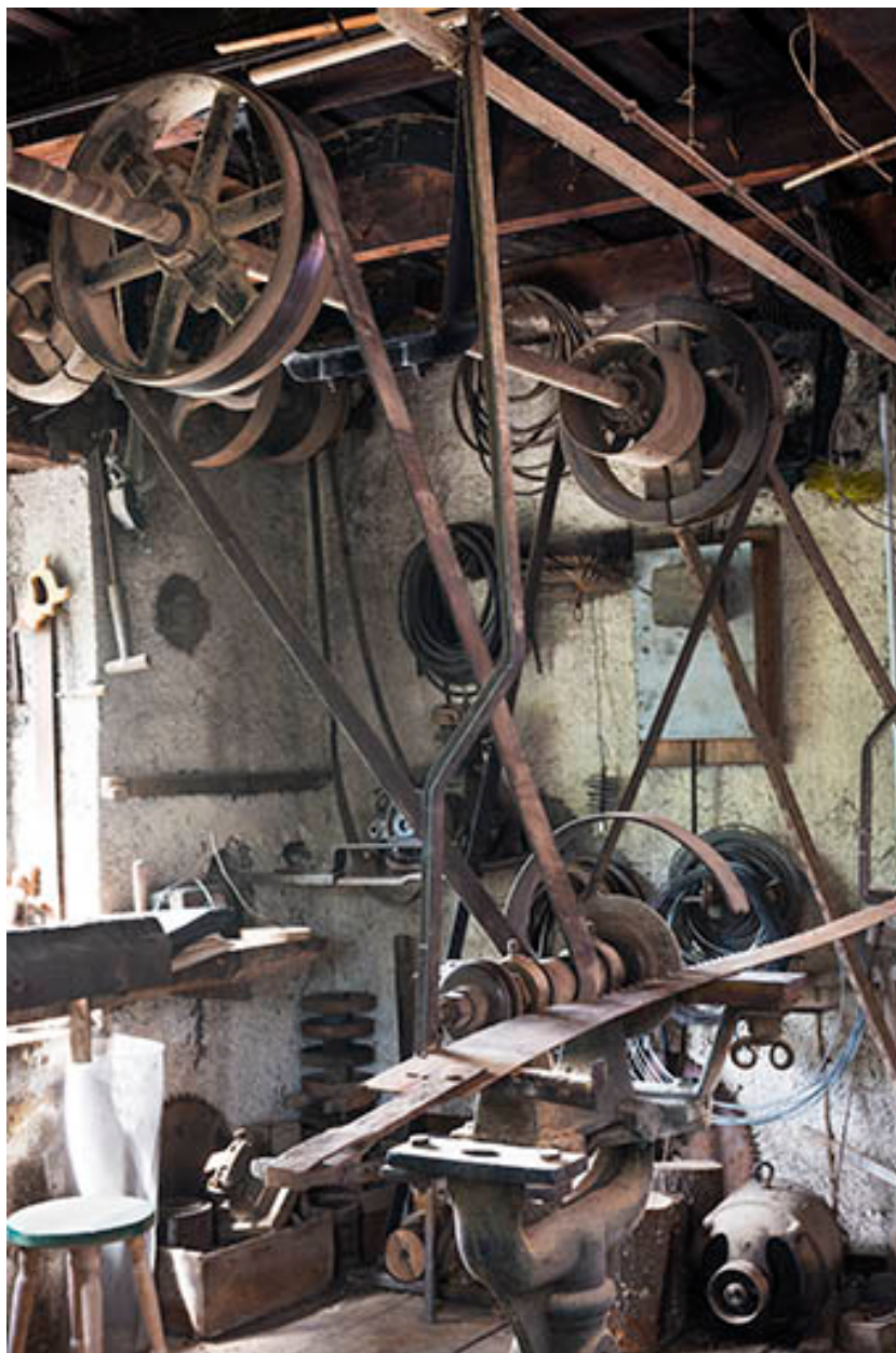
Affûteuse avec son mécanisme de transmission.
