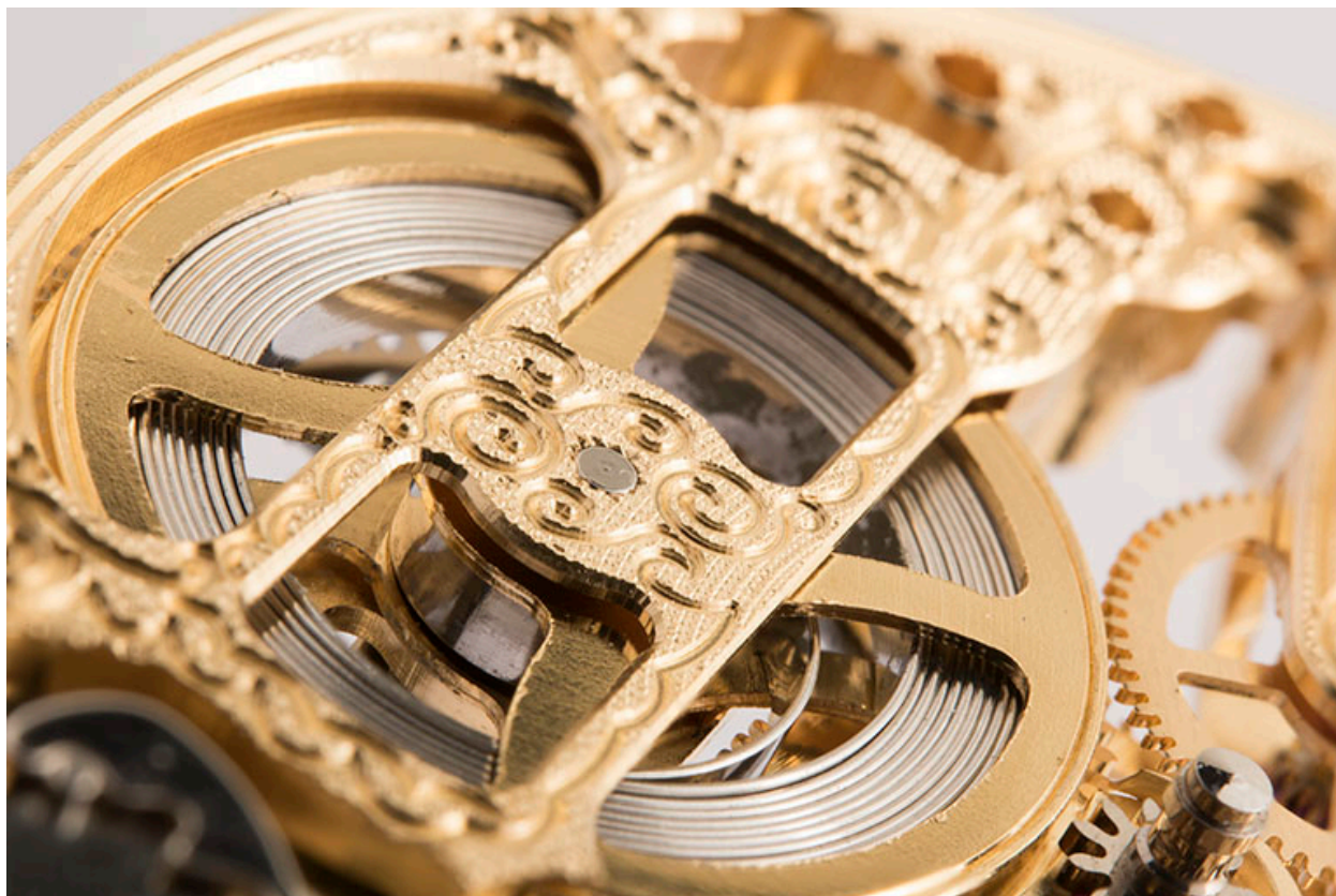
Détail : pont guilloché et ressort moteur.
