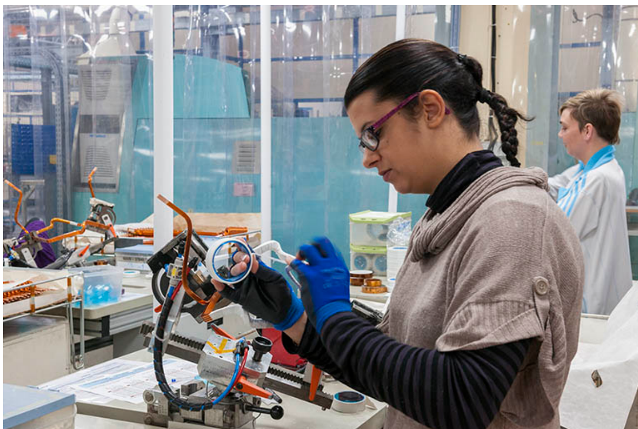
Isolation manuelle des barres de cuivre.
