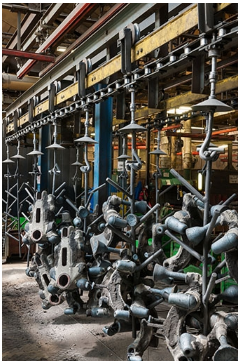
Pièces au dessablage (grenailleuse).
