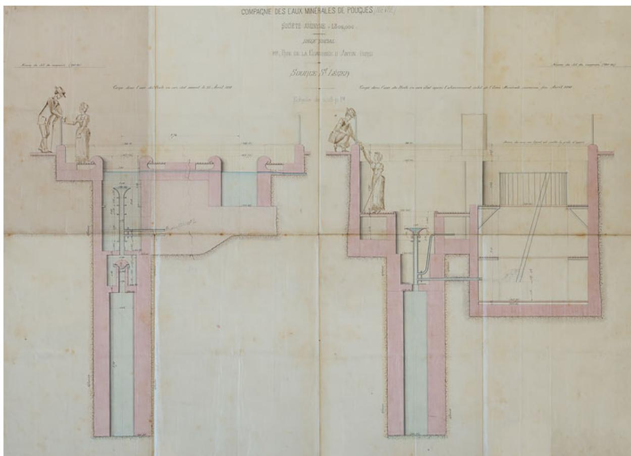
Coupe sur les deux puits avant et après l'abaissement du niveau de l'eau survenu fin avril 1891.
