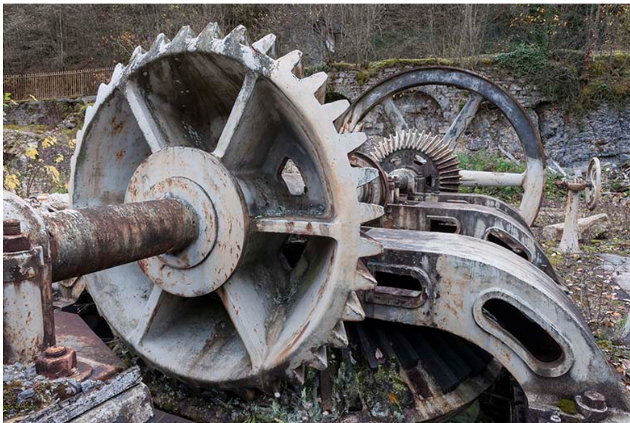
Turbine double. Transmission par engrenage conique.
