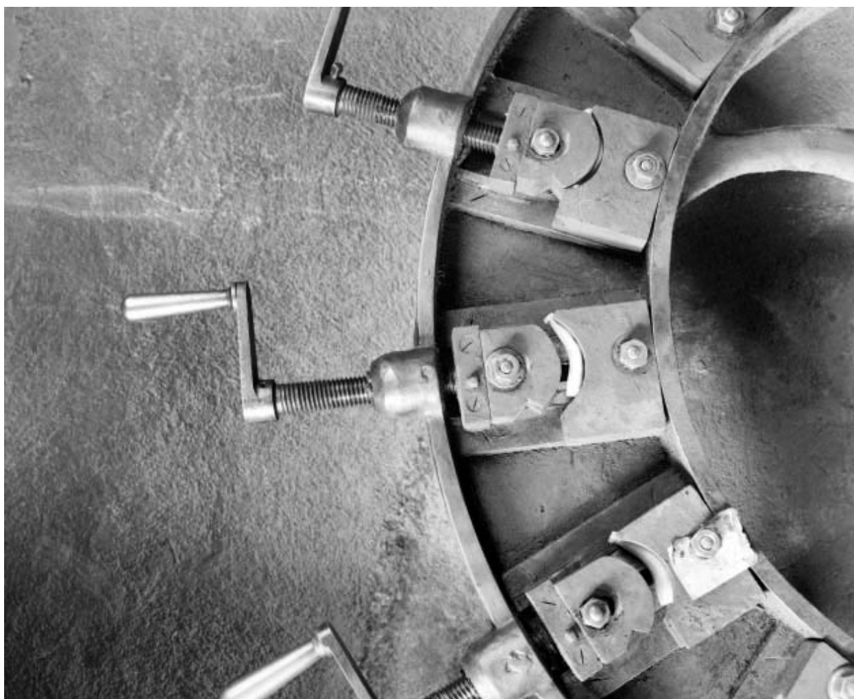
Détail de la machine à cintrer les tuyaux en corne.
