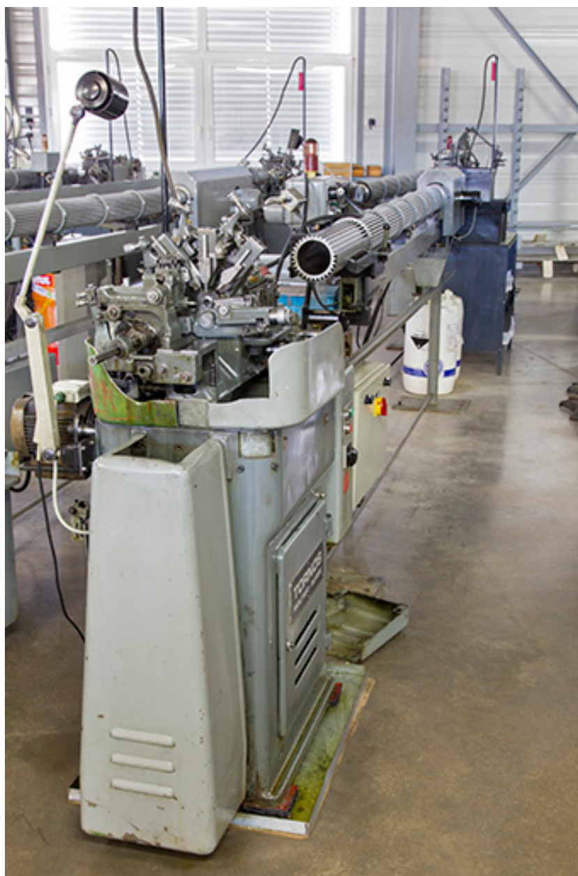
Machine à décolleter Tornos et son ravitailleur.
