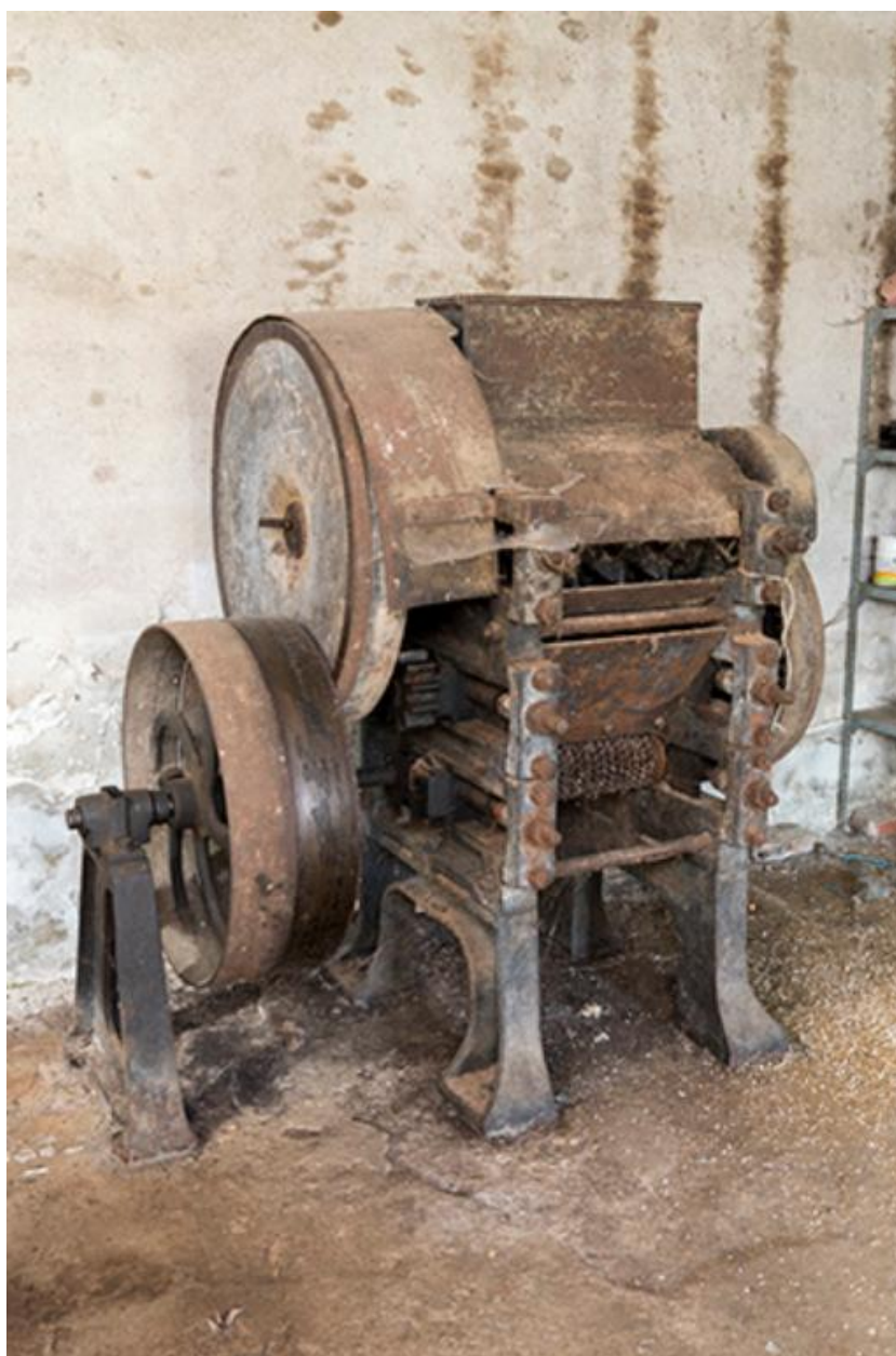
Machine du rez-de-chaussée: broyeur à tourteaux
