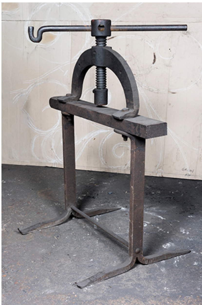
Presse à vis de fabrication artisanale.
