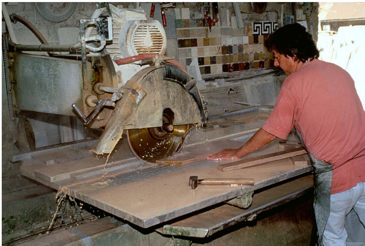
Usine de taille de matériaux de construction Yelmini Artaud, à Balanod : débitage de plinthes en marbre de Balanod.
