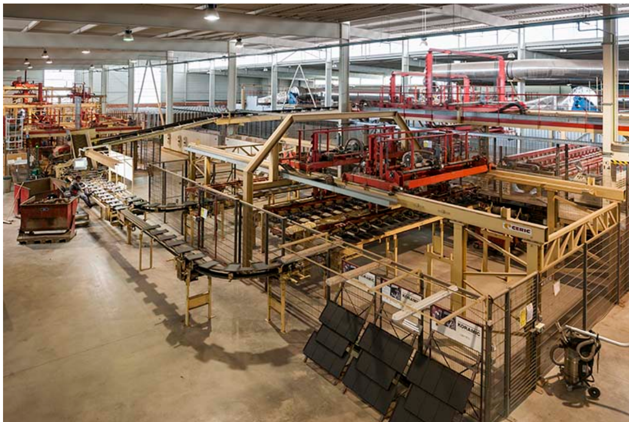
Unité de fabrication dite UL 5. Acheminement des tuiles cuites vers le contrôle.
