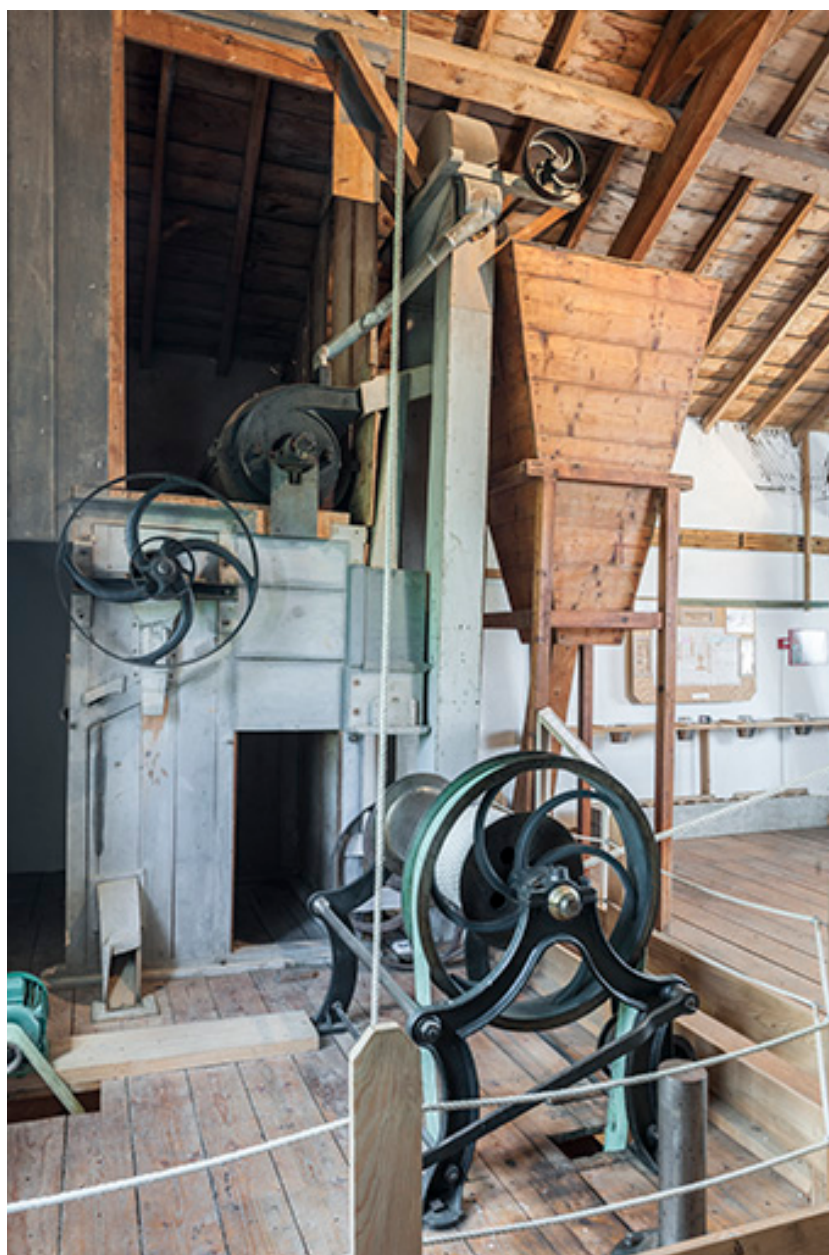
Deuxième étage. Silo, trémie et treuil du monte-sac.
