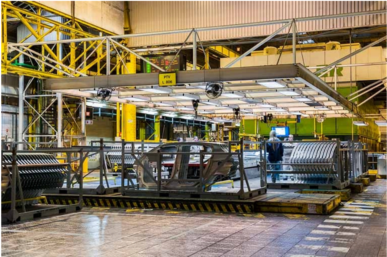
Atelier d'emboutissage. Production des côtés de caisse (presse Schuler).
