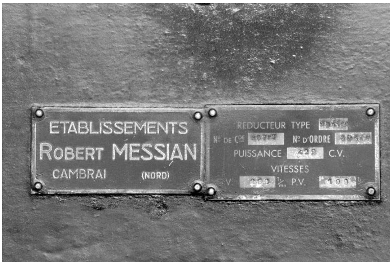
Plaque de constructeur du réducteur Messian.
