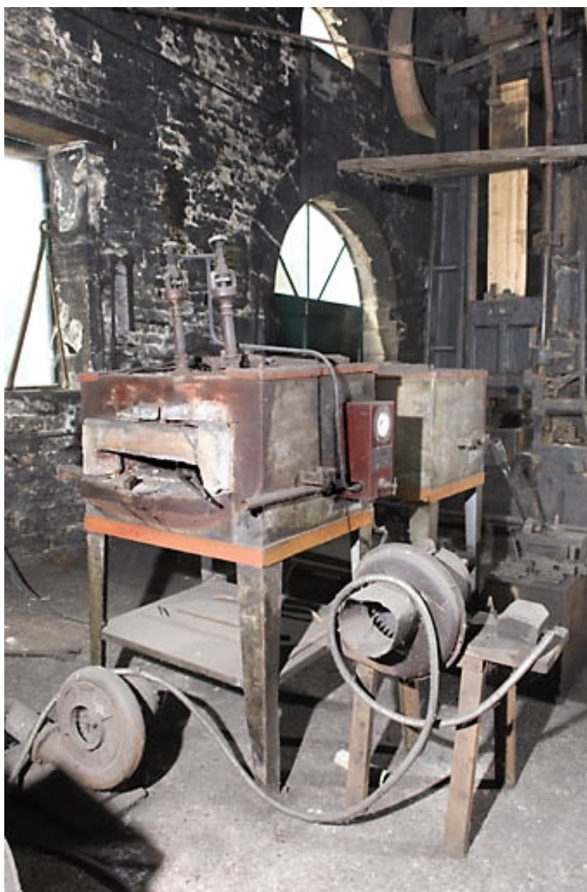
Atelier est. Fours à gaz Thermidor.
