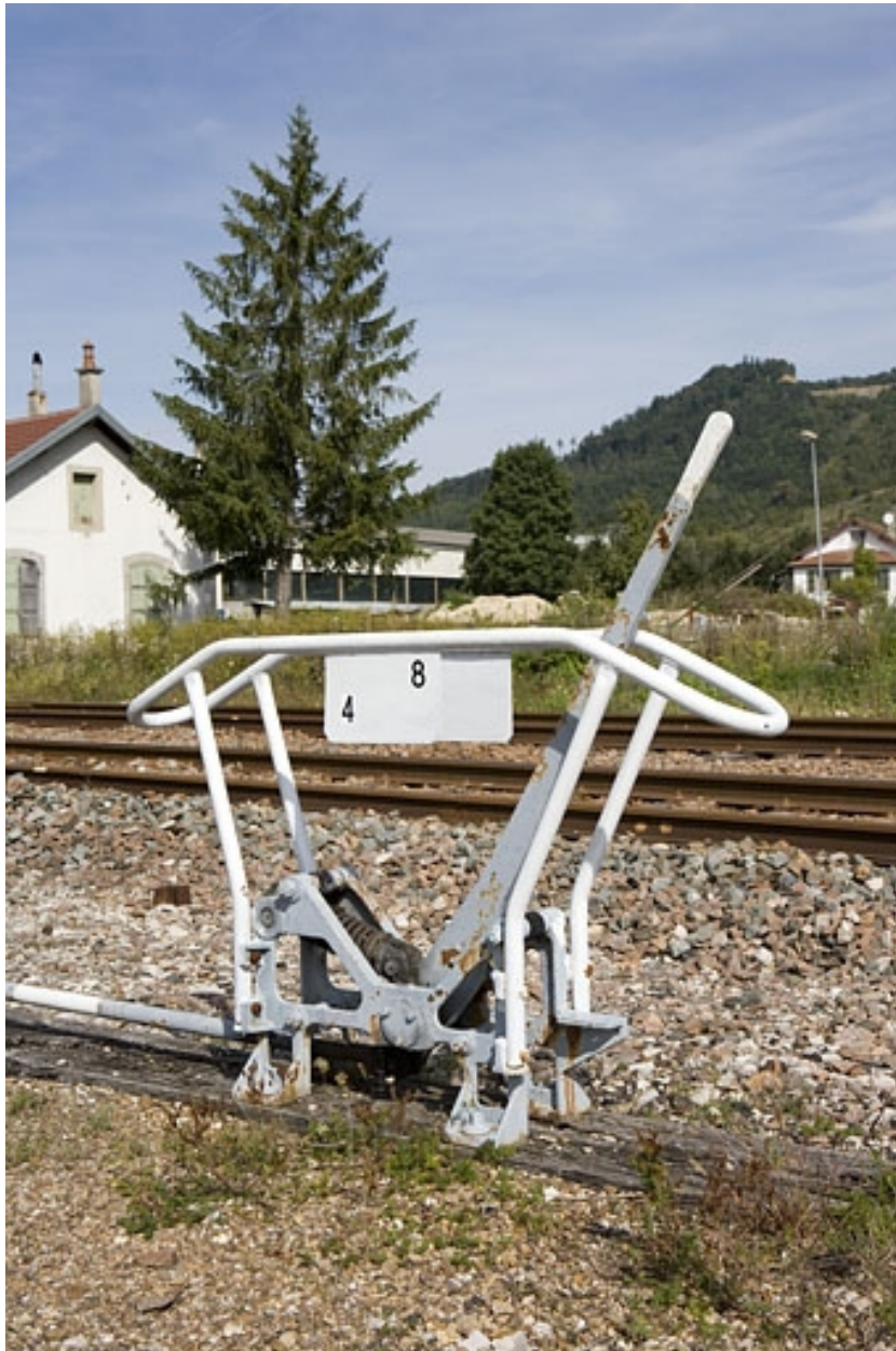
Levier de manoeuvre non enclenché. Levier d'appareil de voie des voies 4 et 8, à l'ouest, à l'extrémité de la gare côté La Cluse.
