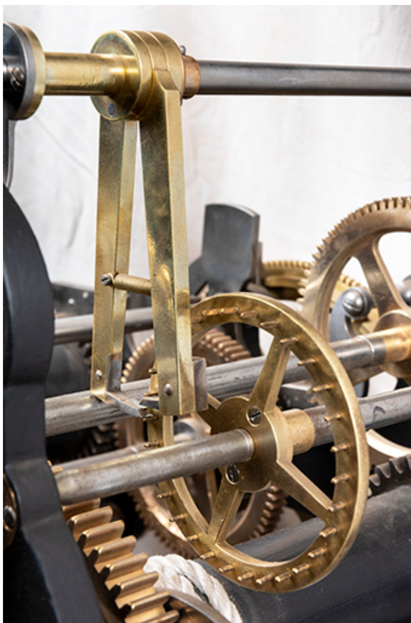
Mouvement, mécanisme des heures : échappement à chevilles.
