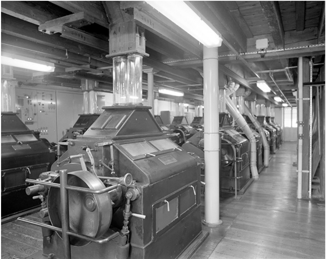
Atelier de fabrication (L), 1er étage : rangée d'appareils à cylindres.
