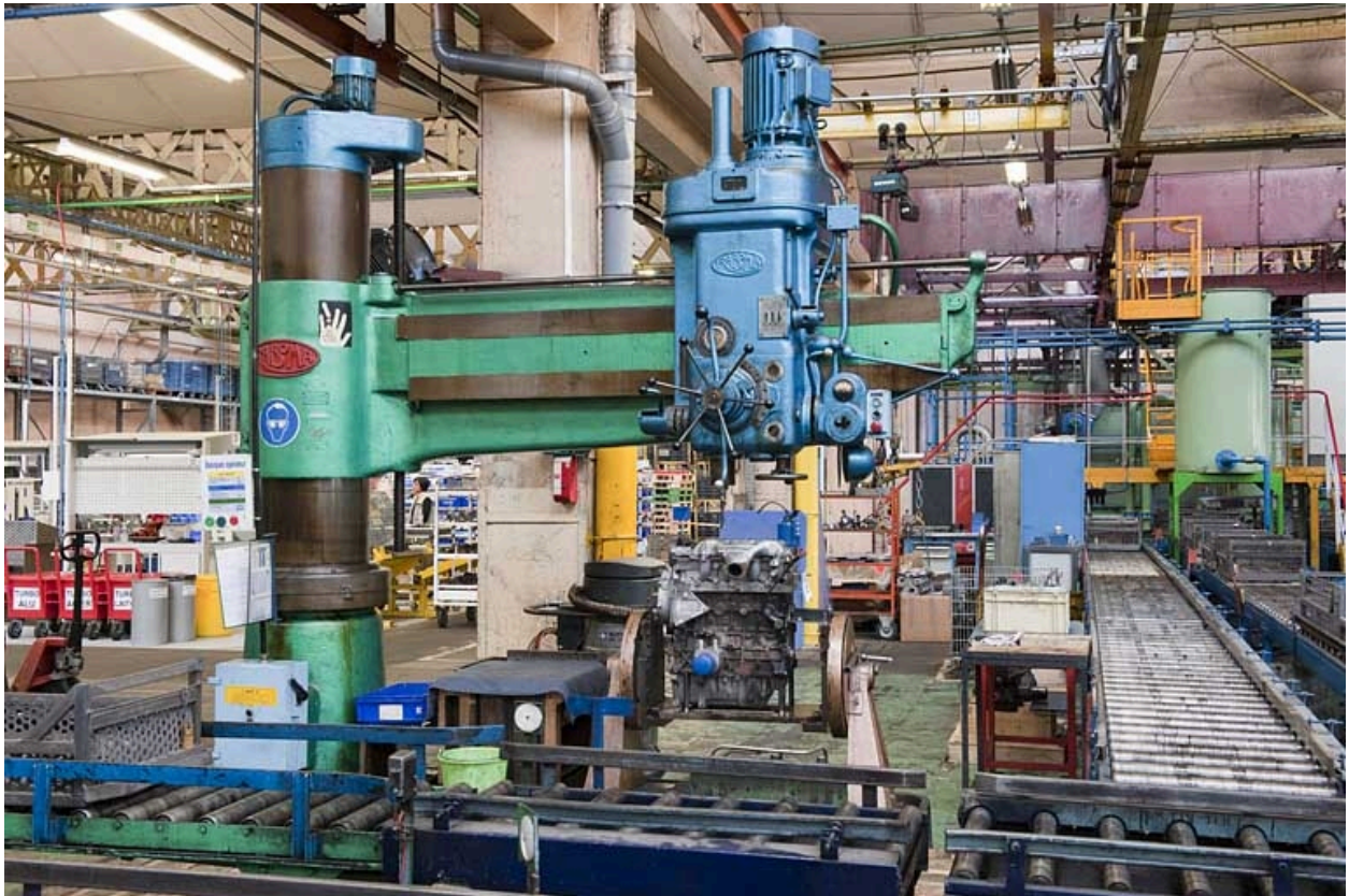
Atelier de rénovation des moteurs. Perceuse Rabora.
