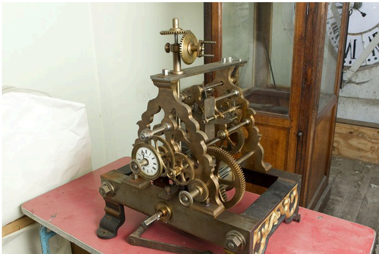
Mouvement (2010) : cadran de contrôle et roues dentées.
