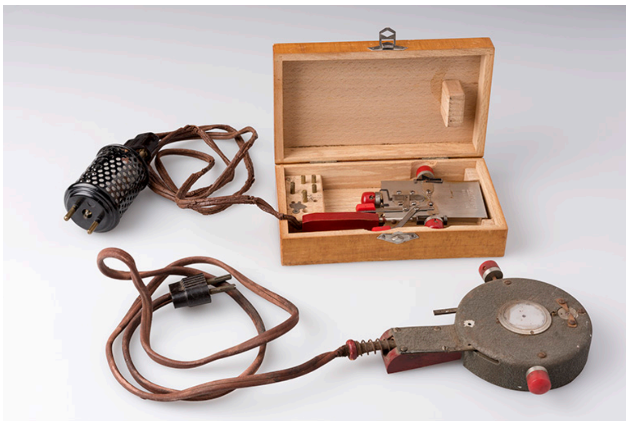
Echappemètres (Microchapp) d'André Leiser (Morteau).
