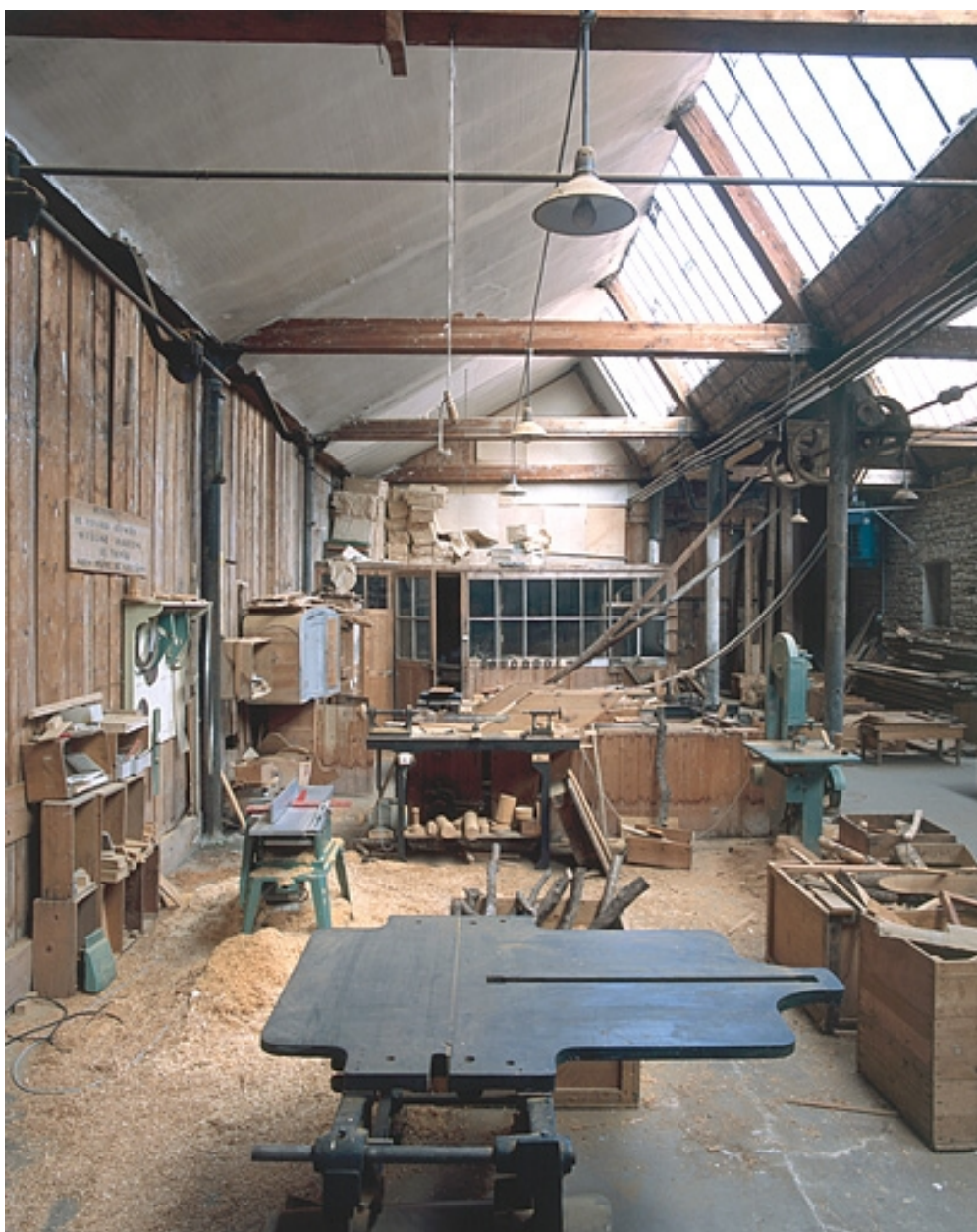
Atelier de menuiserie. Distribution par courroies obliques des machines situées au sud de l'atelier.
