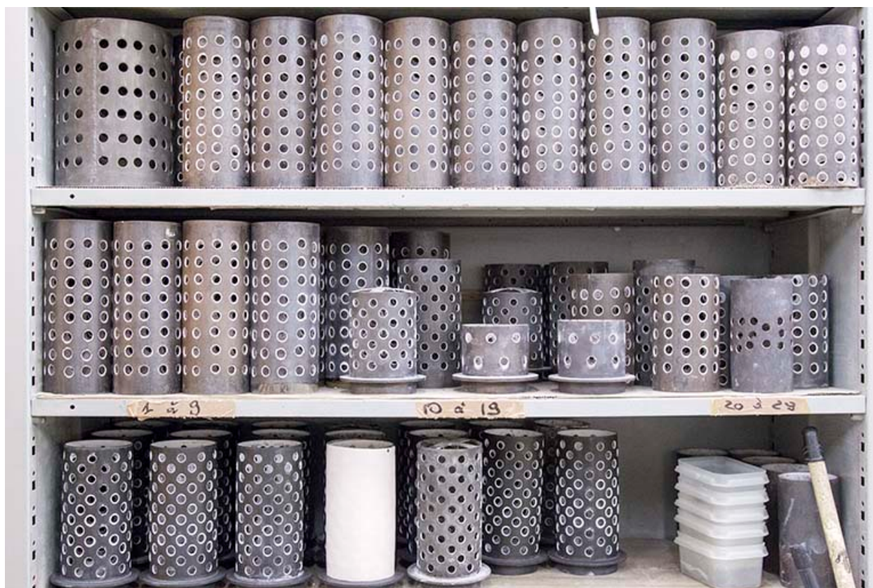
Fonte à la cire perdue : cylindres pour moules réfractaires.
