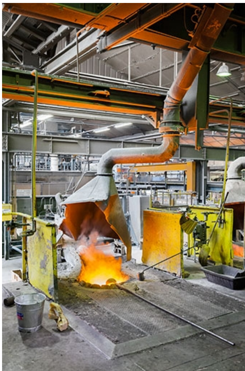
Four à induction en service.
