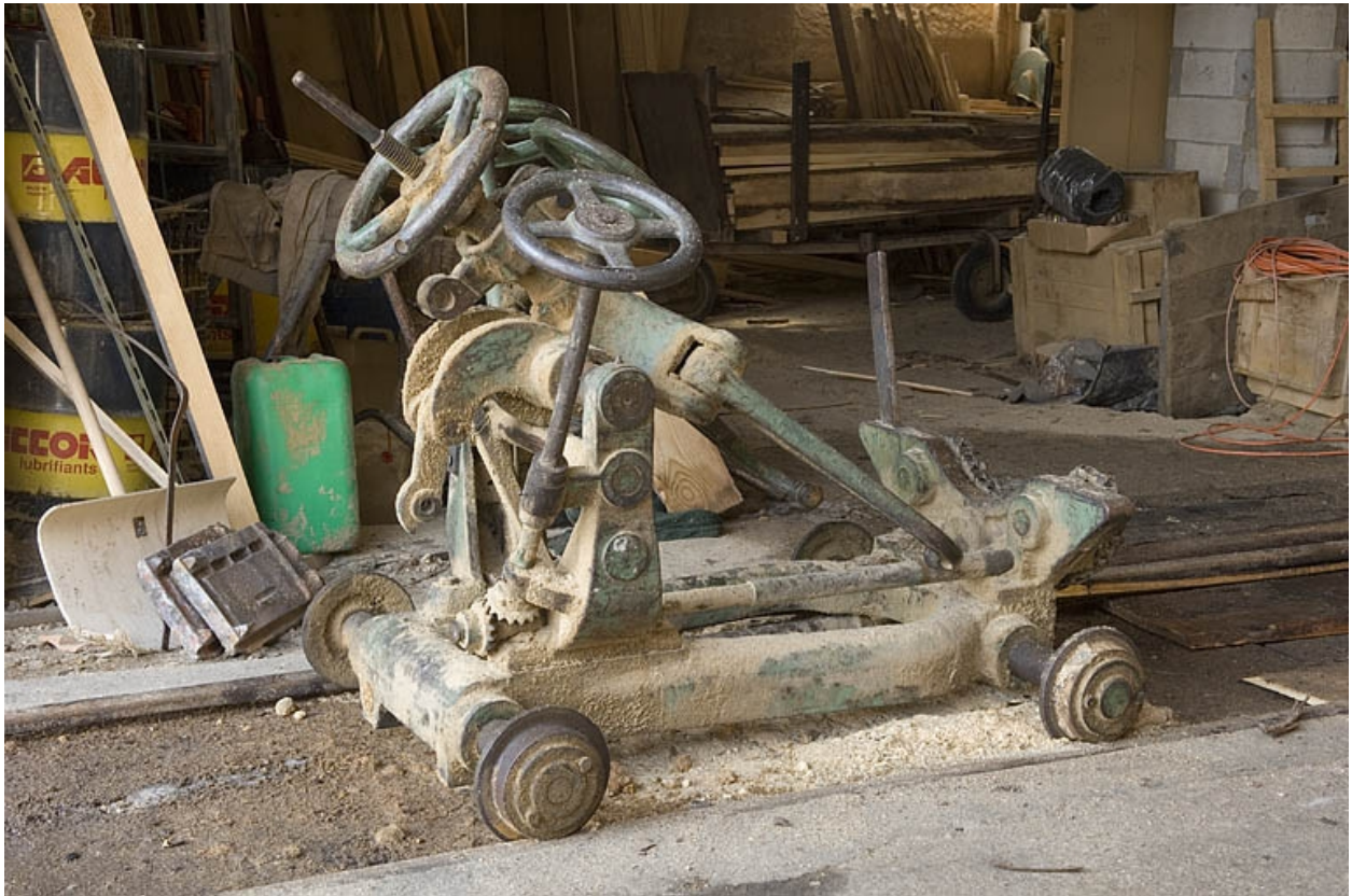
Chariot porte-grumes de la scie déligneuse Socolest.
