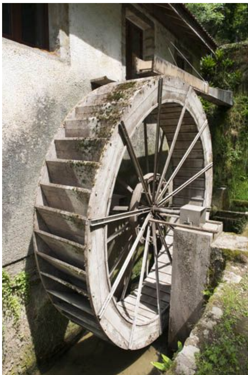
Moulin de la Doue à Abbévillers. Roue hydraulique "en-dessus".
