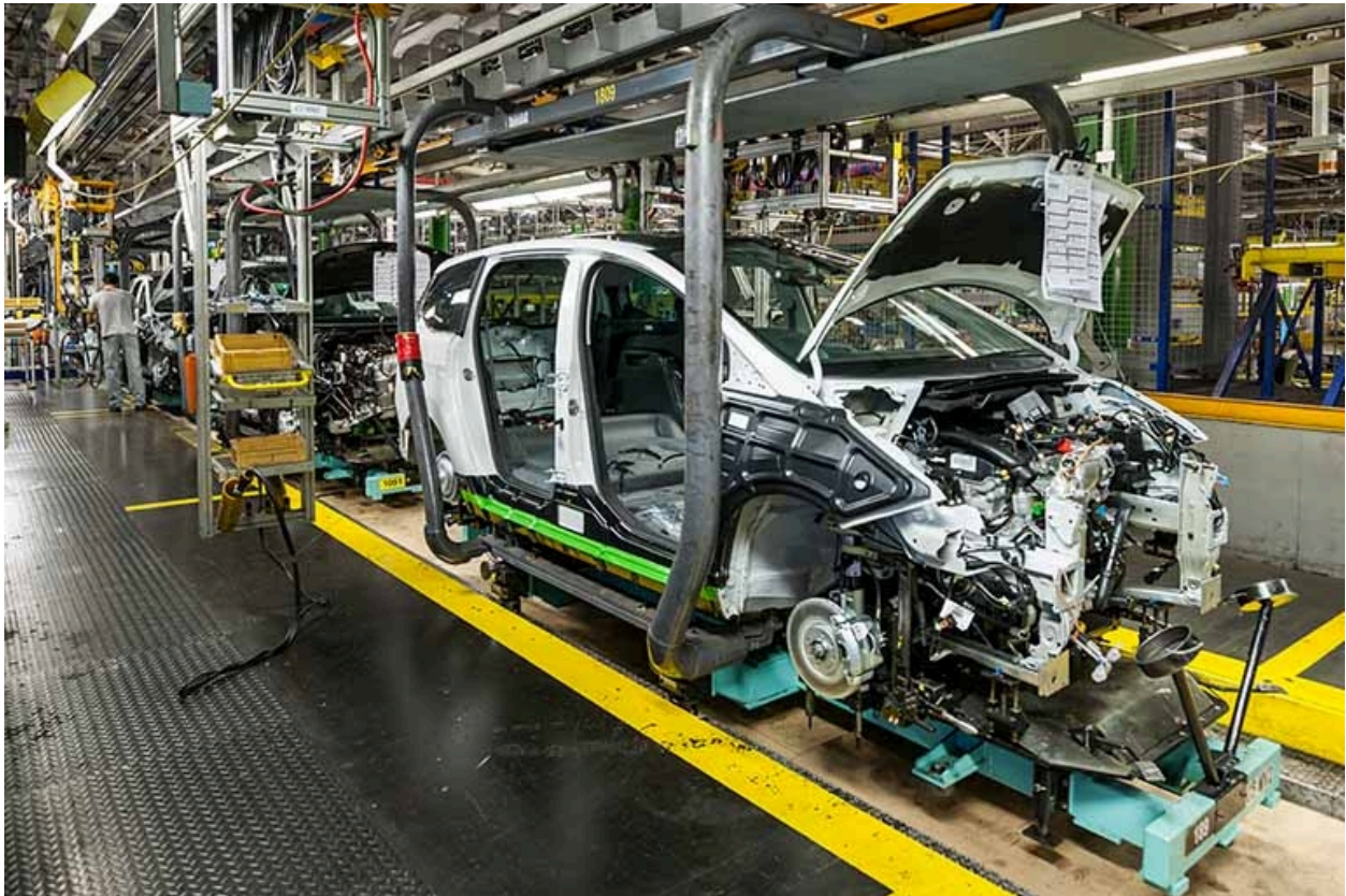
Atelier de montage. Opération de coiffage (3).
