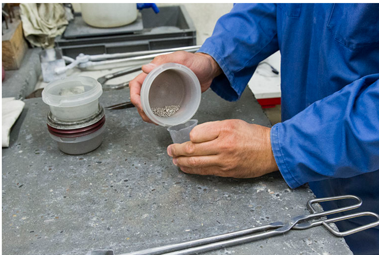
Fonte à la cire perdue : préparation du métal (argent) pour la fonte.
