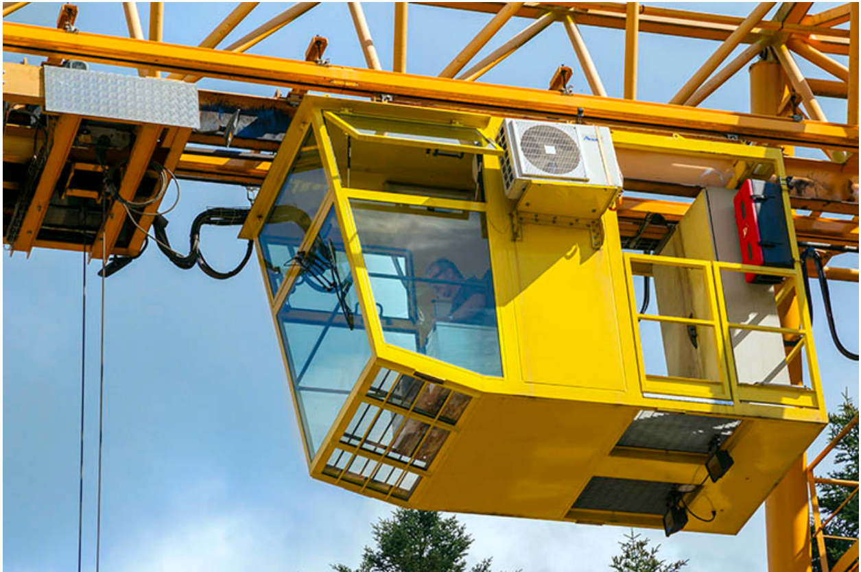
Portique roulant : cabine de commande.
